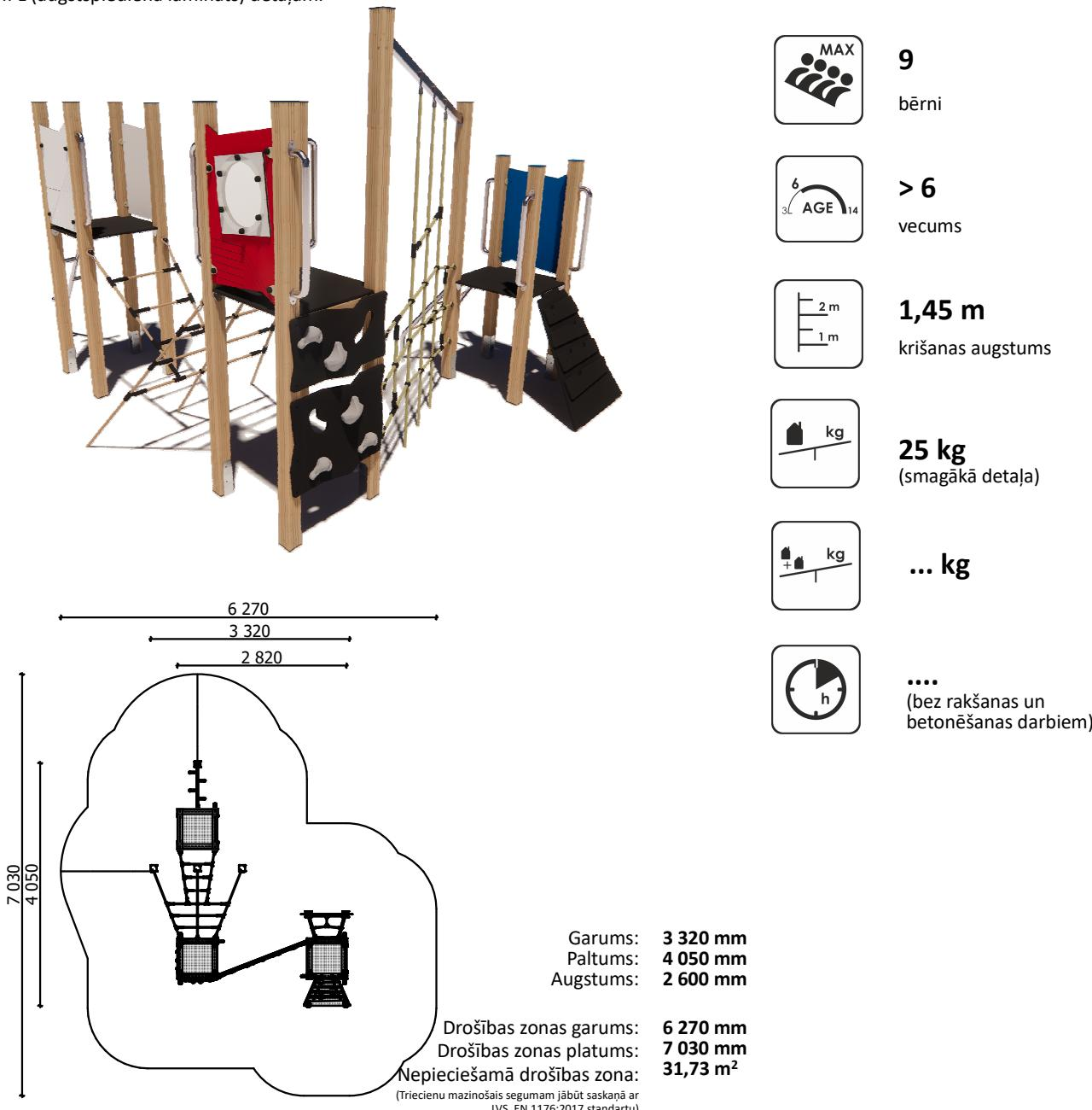
Rotaļu iekārtu tiek nostiprināta, betonējot metāla pamatus, iekārtas uzstādīšanas vietā. Rotaļu iekārtu drīkst izmantot tikai pēc divām dienām, kad betons ir pilnībā sacietējis. Montāžas un betonēšanas laikā, drošības zonā nedrīkst atrasties bērni.
