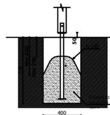
Rotaļu iekārta tiek nostiprināta, betonējot metāla pamatus, iekārtas uzstādīšanas vietā. Rotaļu iekārtu drīkst izmantot tikai pēc divām dienām, kad betons ir pilnībā sacietējis. Montāžas un betonēšanas laikā, drošības zonā nedrīkst atrasties bērni.
