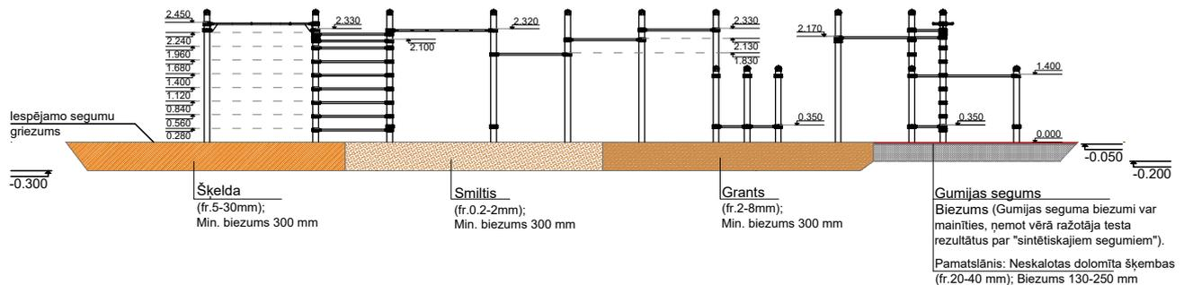
Seguma veidam un tā slāņa biezumam jābūt atbilstošam pēc EN1177 standarta prasībām, ņemot vērā iekārtas krišanas augstumu.
