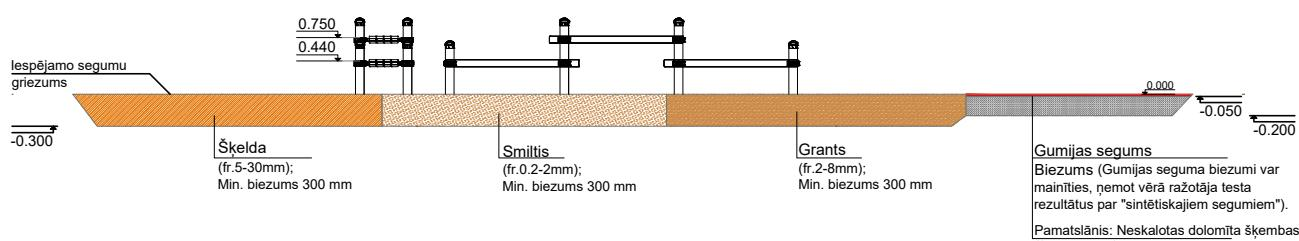
Seguma veidam un tā slāņa biezumam jābūt atbilstošam pēc EN1177 standarta prasībām, nemot vērā iekārtas krišanas augstumu.
