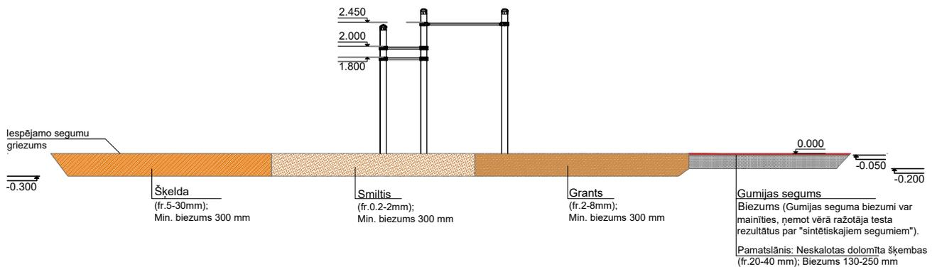
Seguma veidam un tā slāņa biezumam jābūt atbilstošam pēc EN1177 standarta prasībām, ņemot vērā iekārtas krišanas augstumu.
