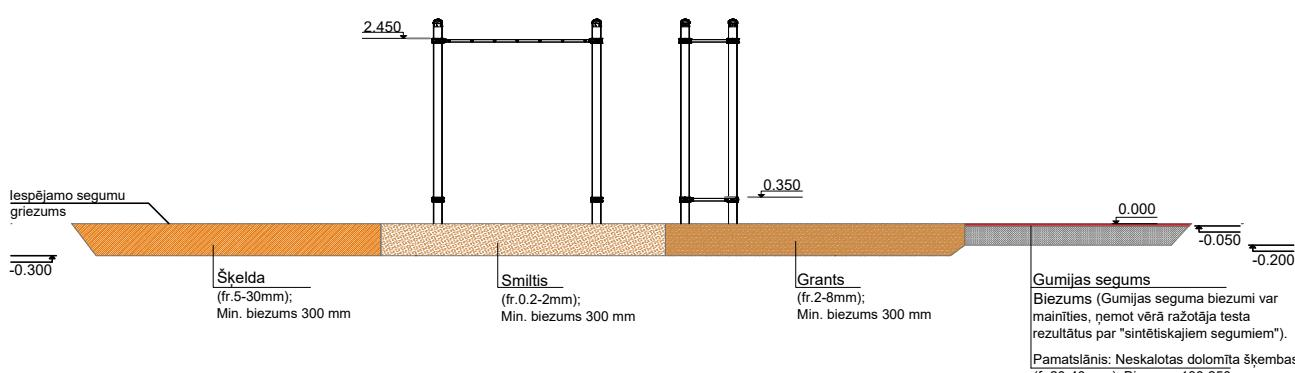
Seguma veidam un tā slāņa biezumam jābūt atbilstošam pēc EN1177 standarta prasībām, nemot vērā iekārtas krišanas augstumu.
